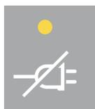
Se for detetada uma falha de energia, a luz de falha de energia acende-se e soa um alarme.
