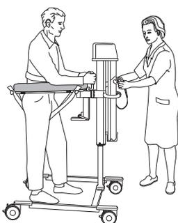
16 Ajuste la altura del sistema de ayuda *Walker*. El ajuste de altura permite la reducción del peso corporal variable. (Consulte la fig. 5)
