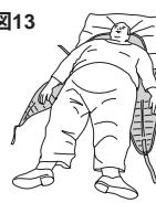
26. レッグストラップを交差させます。片方のストラップをもう片方を通して引っ張ります。(図8を参照)
