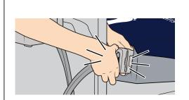
Para terapia ativa (alternada), ligue o conector do conjunto de tubos da bomba, certificando-se de que encaixa em ambos os lados (clique duplo).
