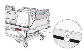
Coloque o cabo de alimentação nas presilhas de passagem para cabos no lado esquerdo da cobertura inferior do colchão. Fixe o cabo utilizando as seis presilhas para cabos com clipes de bloqueio.
