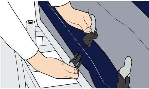
11. Klappen Sie das Seitenpolster auf den Bettrahmen herunter. Stellen Sie sicher, dass das Seitenpolster fest in der Erweiterung sitzt und bündig mit der Matratze abschließt.
