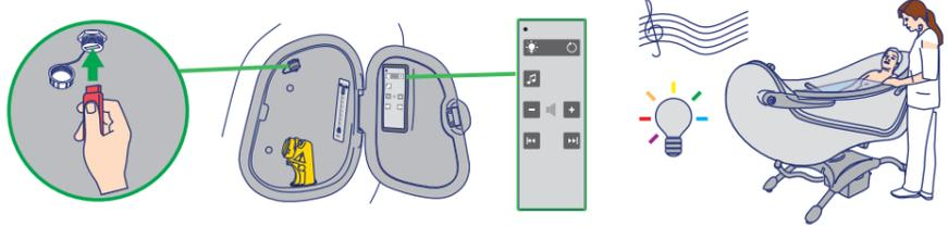
Desenrosque la tapa e inserte el dispositivo USB.
