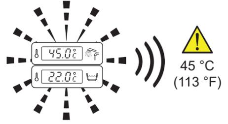
La temperatura parpadea y emite un pitido. El agua se detiene automáticamente al cabo de 10 segundos.
