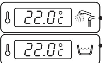
Indica la temperatura del agua de llenado, de la ducha activa o de la mezcla desinfectante.
