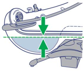
Pulse el botón de llenado automático. El llenado se detiene automáticamente al alcanzar el nivel de agua adecuado.
