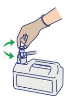
**Determina la proporción de mezcla del desinfectante:** Rocíe la bañera con desinfectante. Compruebe en el caudalímetro que la proporción de mezcla es correcta. Ajuste el mando de la manguera de succión si es necesario.
