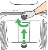
Abra el desagüe. Desacople y coloque todos los accesorios en la parte inferior de la bañera.
