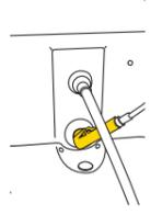
Pulverice desinfectante en el interior de la entrada de aspiración hasta que desborde por la manguera.
