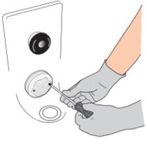
Desatornille los tornillos y retire el filtro de la entrada de aspiración. Limpie el filtro de la entrada de aspiración por separado.
