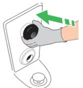
Vuelva a colocar la boquilla en la salida del sistema Hydromassage.
