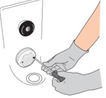
Desatornille los tornillos y retire el filtro de la entrada de aspiración. Limpie el filtro de la entrada de aspiración por separado.
