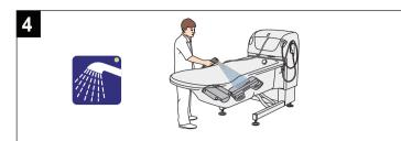
Вымойте под душем и ополосните ванну и принадлежности водой, чтобы удалить видимые загрязнения. Переверните принадлежности и снова промойте
