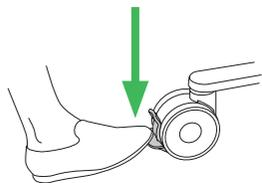
必要な場合、ベッドのブレーキをかけます。介助者側のベッドレールを下に下げます。
