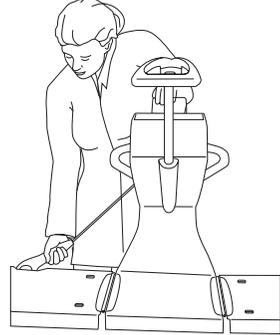
背もたれとして機能する入浴用リフトローリーの側面にフックロープを固定します。
