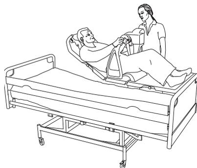
入浴用リフトトロリーの高さを調整し、ベッド上で可能な限り遠くに移動させます。
