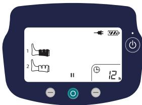
Часы отображаются по умолчанию при каждом включении помпы. Символом «h» отмечается значение в часах (например, 12 h).
