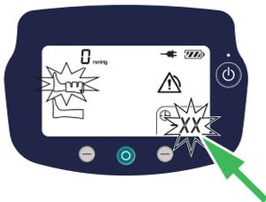
3. Dopo 1 ora di non conformità monitorata, il display passa a visualizzare il tempo in ore, in modalità lampeggiante.
