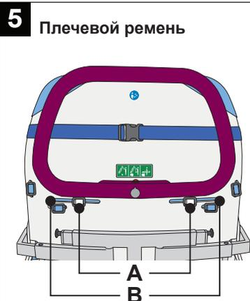
Вставьте два скользящих фиксатора (А) в верхние концы прорезей (В).
