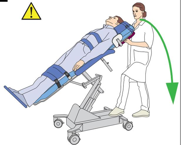
Tire de la mesa inclinable hasta ponerla totalmente en posición horizontal. Apóyese con un pie sobre la barra del chasis.
