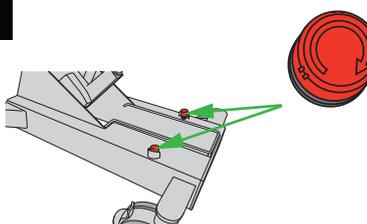
Pulse los botones de parada de emergencia para interrumpir la alimentación de todos los componentes eléctricos.
