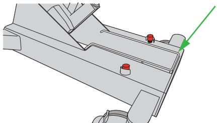
Presione la barra de protección contra enganches para detener automáticamente todo movimiento descendente.
