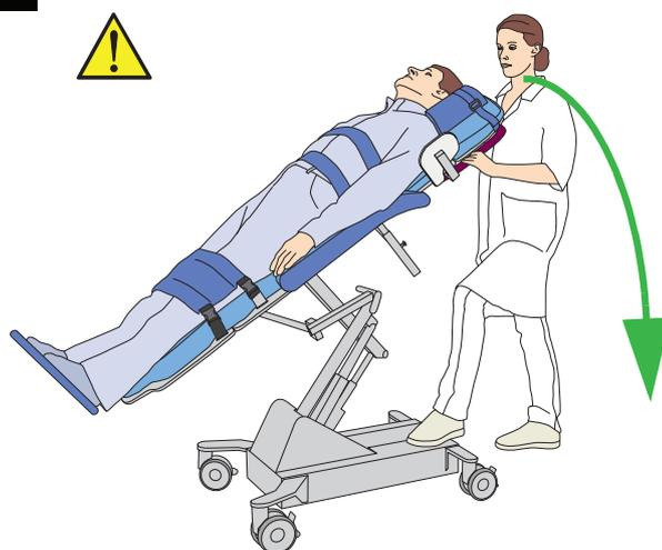
Abbassare il lettino fino alla posizione orizzontale. Per un maggior sostegno tenere un piede sulla traversa dello chassis.
