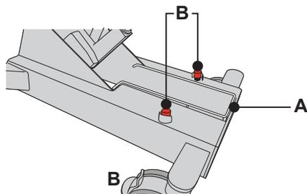
Non attivare la barra di protezione anti-schiacciamento (A) né i pulsanti di emergenza (B).
