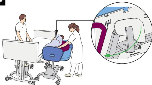
Abbassare il poggiaspalle (B) di Sara Combilizer
