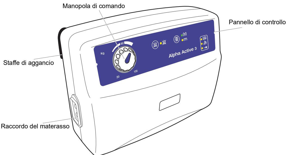
I comandi si trovano sul lato anteriore della pompa. Un sistema di allarme avanzato è in grado di distinguere tra normali errori operativi e veri e propri guasti del sistema. La presenza di una condizione di allarme provoca l'immediata accensione della spia sul lato anteriore della pompa nonché l'emissione di un segnale d'allarme.
