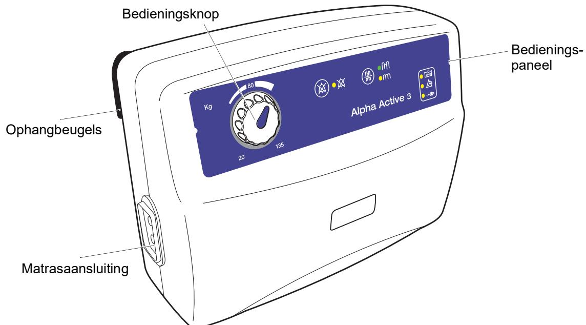
De bedieningselementen bevinden zich aan de voorkant van de therapie-unit. Een alarmsysteem onderscheidt tussen normale werking en echte systeemstoringen. In geval van een alarmsituatie gaat er aan de voorkant van de therapie-unit een indicatielampje branden en wordt er een waarschuwingssignaal afgegeven.
