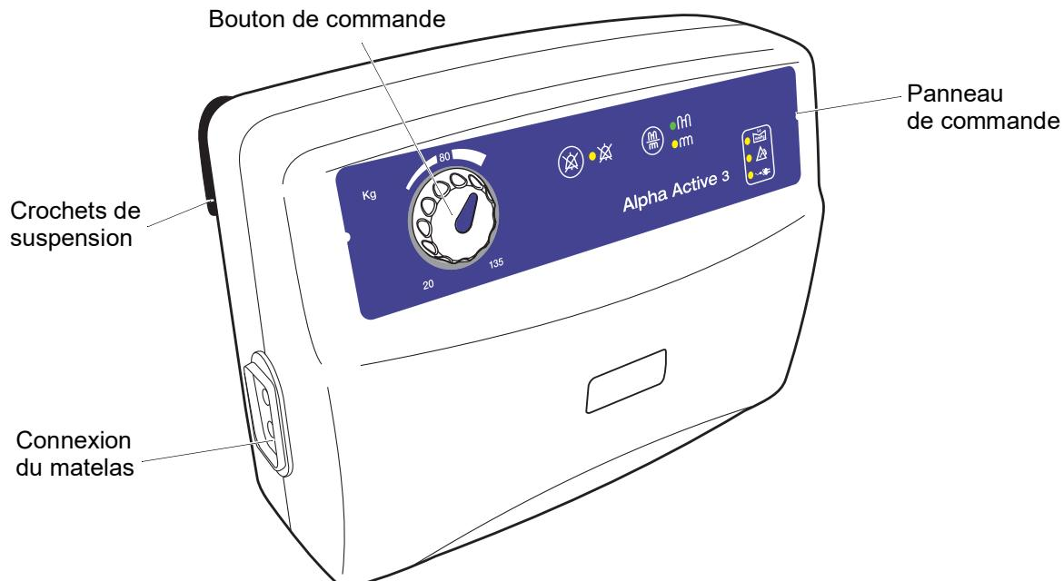
Les commandes sont situées à l'avant de la pompe. Un système d'alarme fait la différence entre un mode de fonctionnement normal et de réels problèmes de fonctionnement. Si une situation d'urgence est détectée, un voyant s'allume à l'avant de la pompe et un signal d'avertissement retentit.
